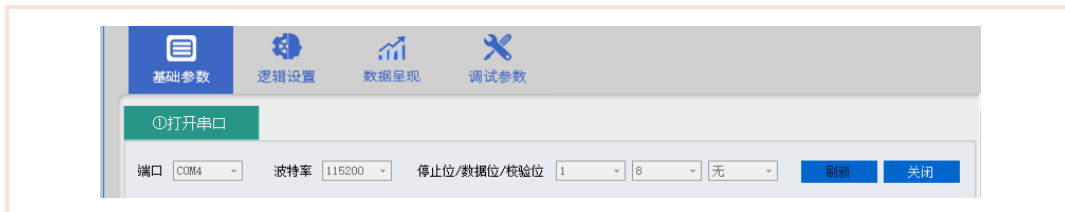
图 3 设置软件串口配置
