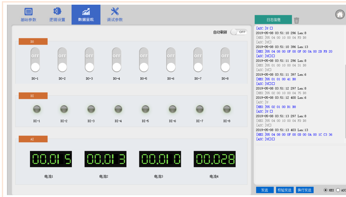
图 6 获取设备 DO、DI、AI 状态
